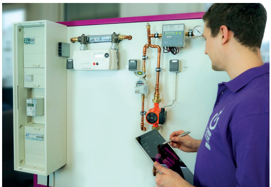
Laborwand für das Mehrsparten-Metering
